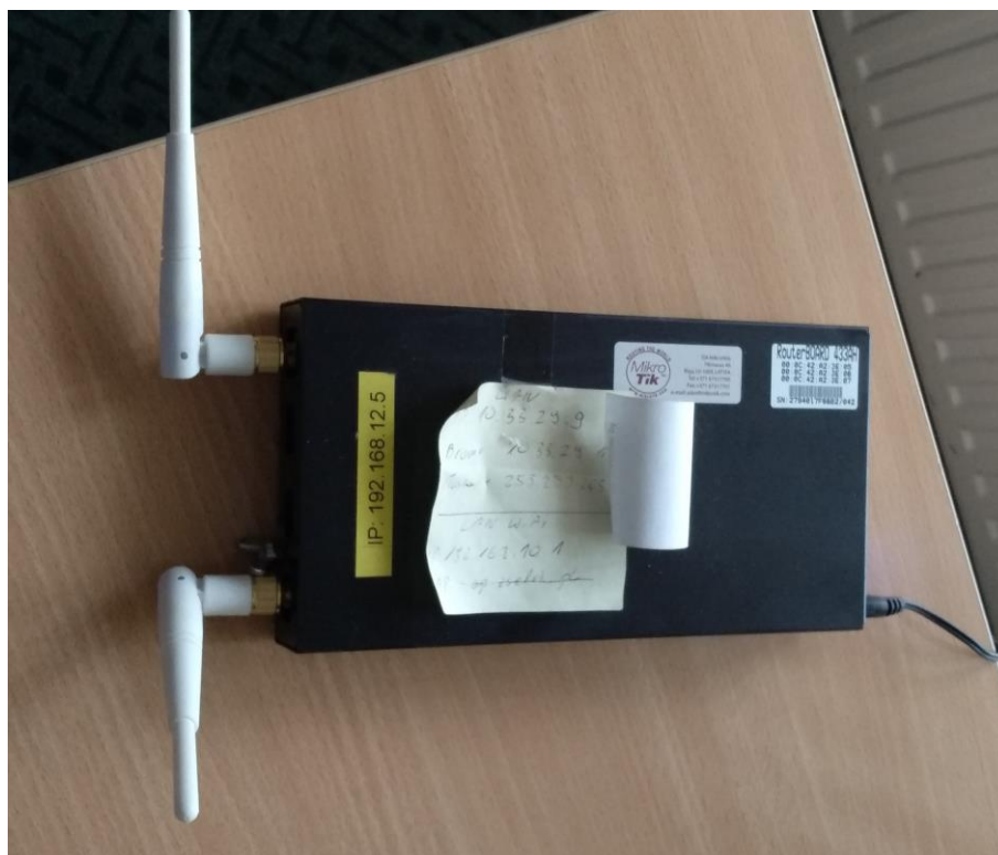
Fot. 1: Zdjęcie punktu dostępowego model RB433AH
