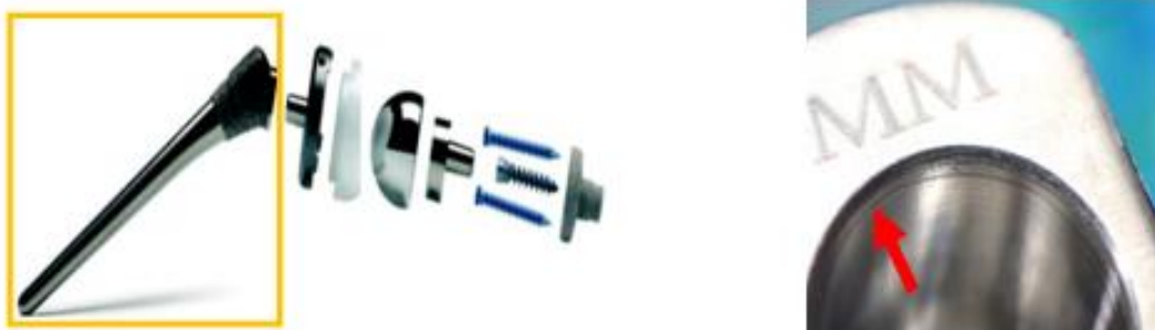
Ryc. 1 – Produkt Comprehensive Shoulder Primary Stem (po lewej) nie był prawidłowo dopasowany z powodu nadmiaru metalu, który został zidentyfikowany na wewnętrznym stożku (po prawej).
