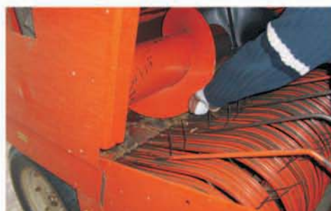
Usuwanie zapchania przy włączonym napędzie (fot. OR Warszawa)
