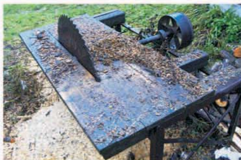
Brak osłon ruchomych części maszyn (fot. OR Białystok i OR Bydgoszcz)
