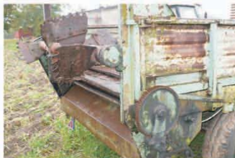
Brak osłon ruchomych części maszyn (fot. OR Białystok i OR Bydgoszcz)
