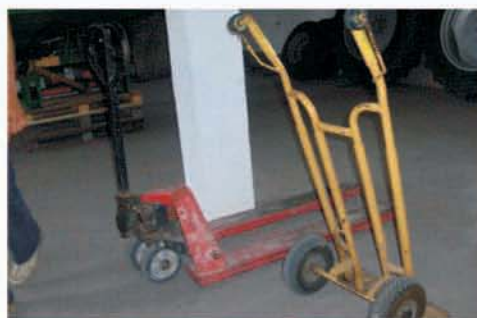
Stosowanie wózków do transportu materiałów zapobiega przygnieceniu i uderzeniu w trakcie ich przemieszczania oraz chroni układ ruchu przed przeciężeniem
