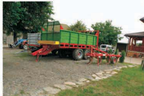
Wydzielone place manewrowe, właściwe ustawienie i zabezpieczenie maszyn i urządzeń oraz stosowanie podpór umożliwiają bezpieczne agregowanie
