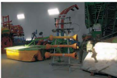
Oslonięcie ruchomych części maszyn i urządzeń zapobiega pochwyteniu i uderzeniu osób obsługujących
