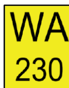
Rys. 10.2. Przykład tablicy informującej o połączeniu awaryjnym
