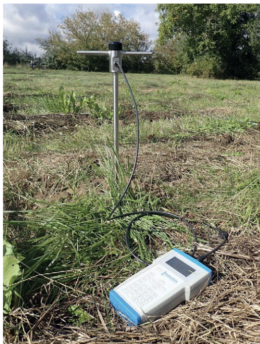
Ryc. 6. Pomiar przewodności termicznej gruntu w otworze za pomocą terenowej sondy igłowej typu Hukseflux
