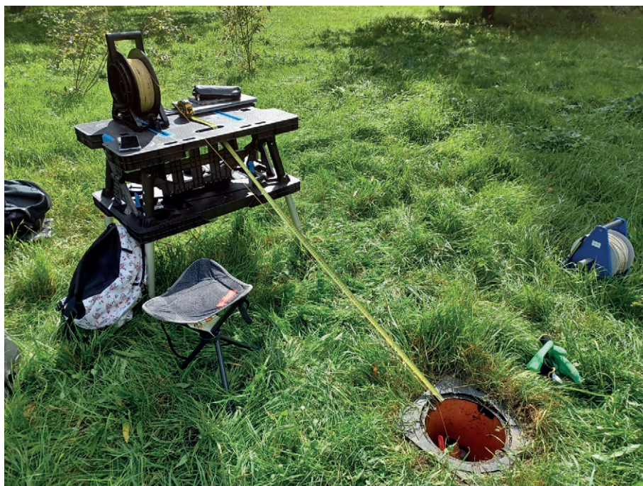
Ryc. 26. Profilowanie temperatury w termopiezometrze TP-1 Wrocław za pomocą rejestratora Solinst zapuszczanego na sznurku kevlarowym w dniu 29.09.2022
