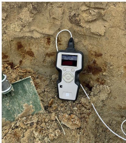
Ryc. 5. Pomiar przewodności termicznej in situ w gruntach czwartorzędowych
