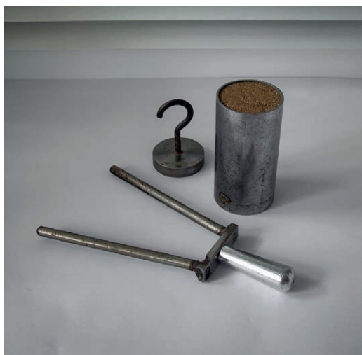
Ryc. 11. Stalowy cylinder z widelkami do formowania próbek gruntów niespoistych
