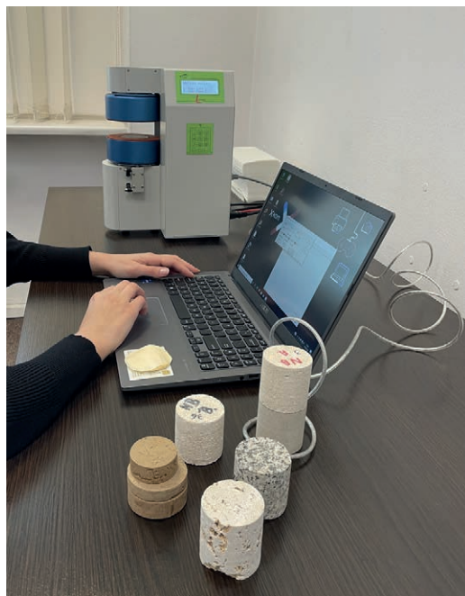
Ryc. 19. Stacjonarna sonda FOX 50 do pomiaru przewodności termicznej w stanie ustalonym
