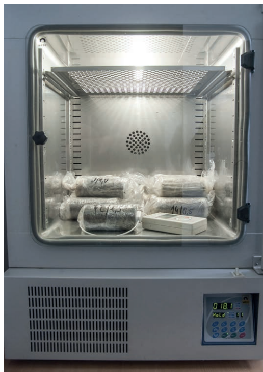
Ryc. 10. Pomiar przewodności termicznej gruntów spoiстых w inkubatorze termicznym
