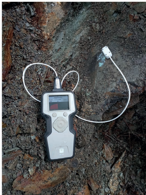
Ryc. 8. Pomiar przewodności termicznej łupków fliszowych w odsłoniętym odsłonięciu
