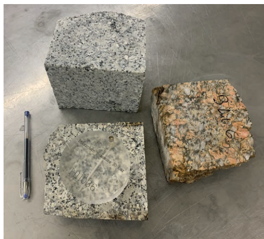
Ryc. 16. Próbkę skal przygotowane do pomiarów przewodności termicznej miernikiem TK04
