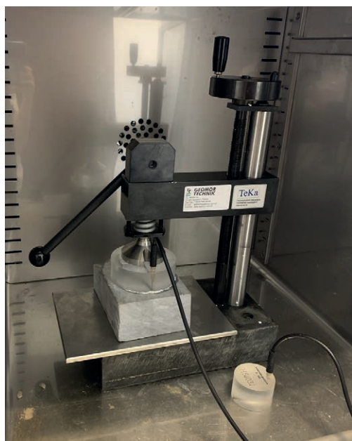
Ryc. 18. Prasa dociskowa do pomiarów przewodności termicznej skal
