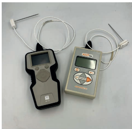
Ryc. 7. Analizatory właściwości termicznych Tempos i KD2 Pro z igłami typu RK do pomiaru przewodności termicznej skał
