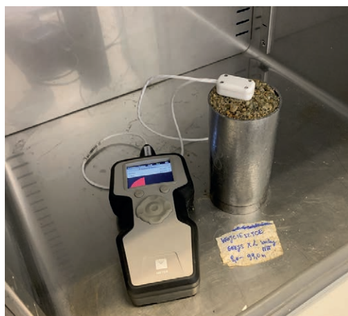
Ryc. 13. Pomiar przewodności termicznej gruntów niespoistych w inkubatorze termicznym
