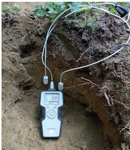
Ryc. 5. Pomiar przewodności termicznej in situ w gruntach czwartorzędowych
