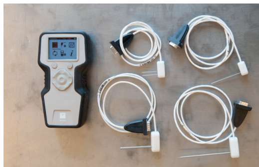
Ryc. 4. Analizator właściwości termicznych Tempos z zestawem sond igłowych do pomiarów przewodności termicznej różnych rodzajów materiałów
