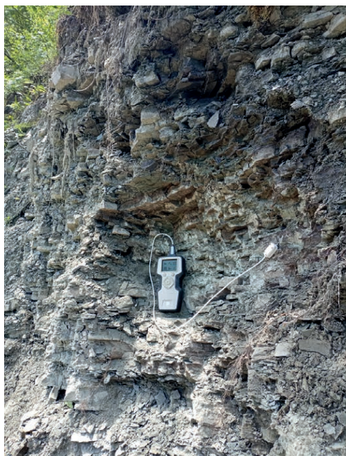
Ryc. 8. Pomiar przewodności termicznej łupków fliszowych w odsłoniętym odsłonięciu
