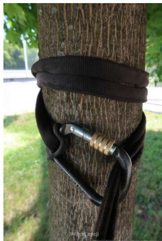
rys. 15 Stanowiska na drzewie, na pniu, stosowane do układów ratowniczych
