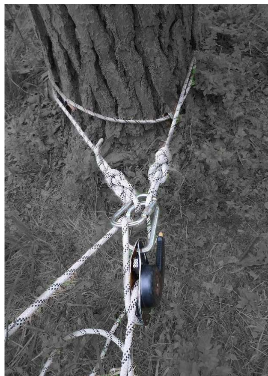
rys. 13 Stanowisko na drzewie przy pniu, stanowisko do układów ratowniczych
