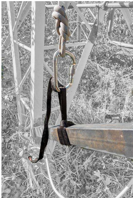
rys. 16 Sposoby zakładania stanowisk na konstrukcji stosowane podczas wycofu
