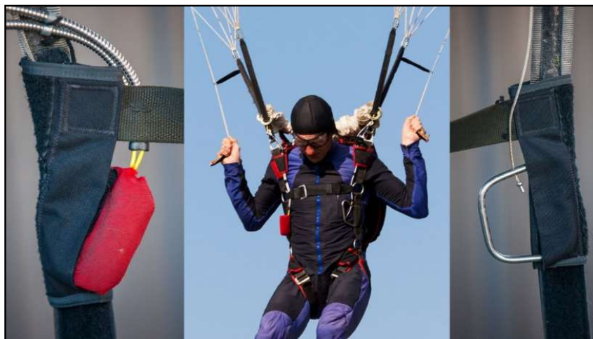
rys. 45 Uprząż skoczka – z systemem zwalniania spadochronu
