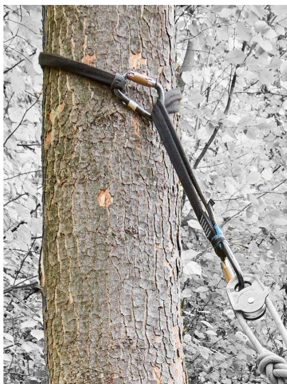
rys. 15 Stanowiska na drzewie, na pniu, stosowane do układów ratowniczych
