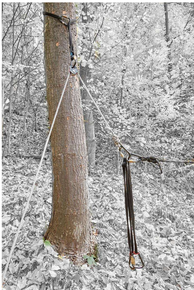
rys. 37 Opuszczanie z odciąganiem
