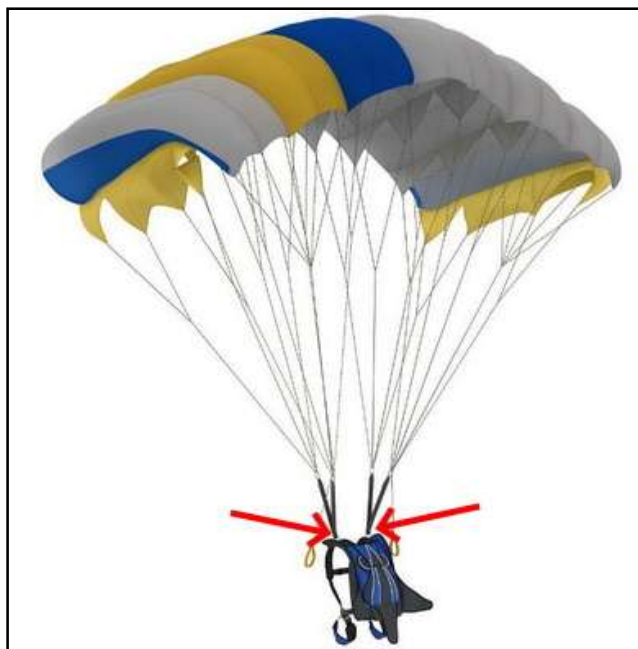
rys. 51 Miejsce cięcia taśm w uprząży lotnika
