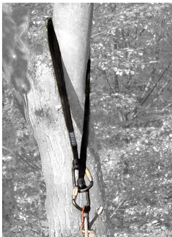
rys. 14 Stanowisko na drzewie, na konarach, stosowane do układów ratowniczych
