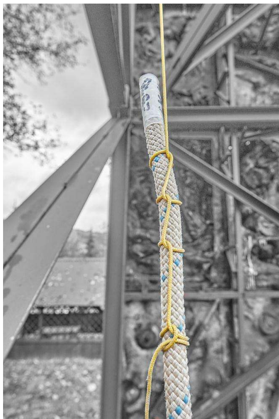
rys. 24 Dowiązanie liny do rzutki
