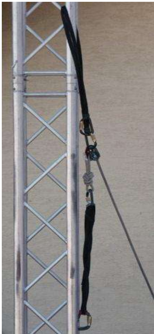
rys. 36 Opuszczanie z dołu
