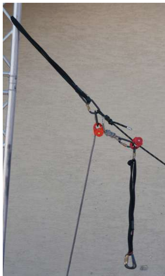
rys. 38 Opuszczanie po linie kierunkowej
