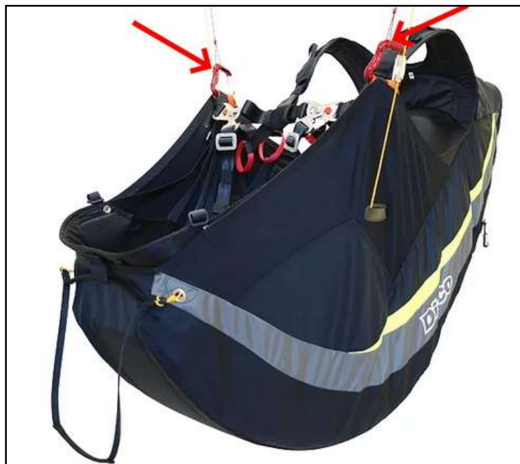
rys. 43 Uprząż paralołtniarza – kokon do długich przelotów (zaznaczono miejsca dopięcia)
