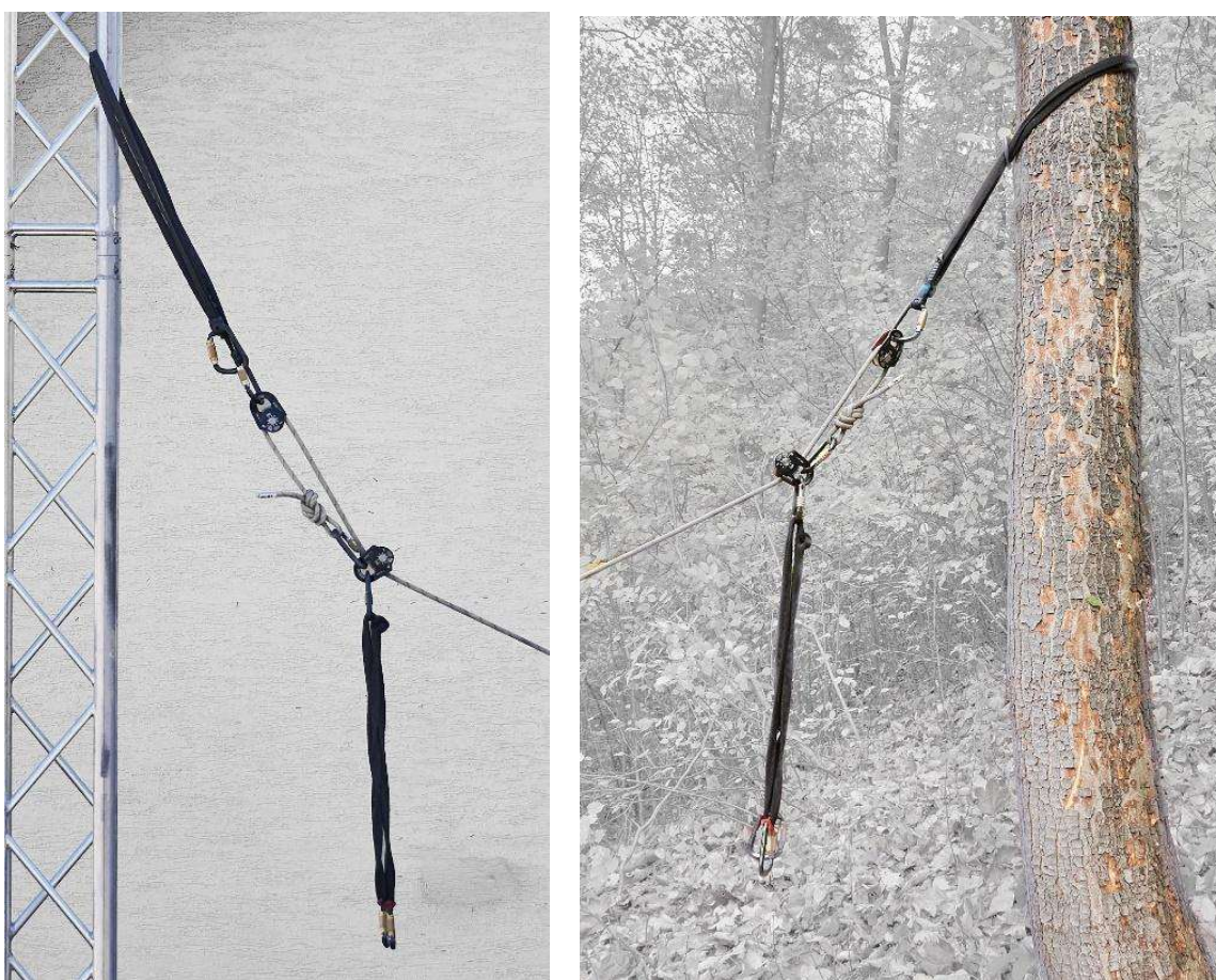
rys.39 Opuszczanie układem samonapinającym
