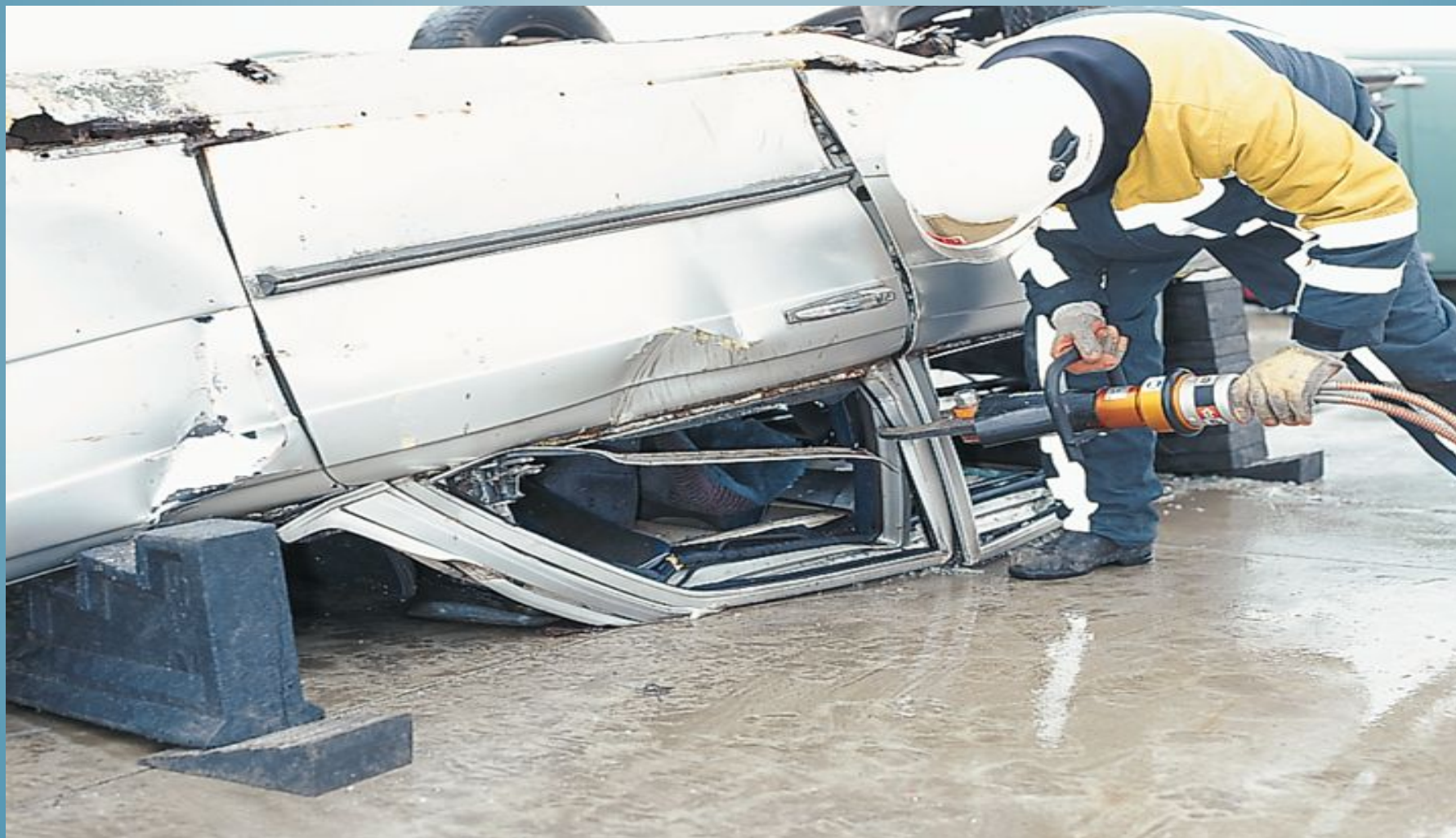
Zdjęcie 2 Stabilizacja pojazdu na dachu
