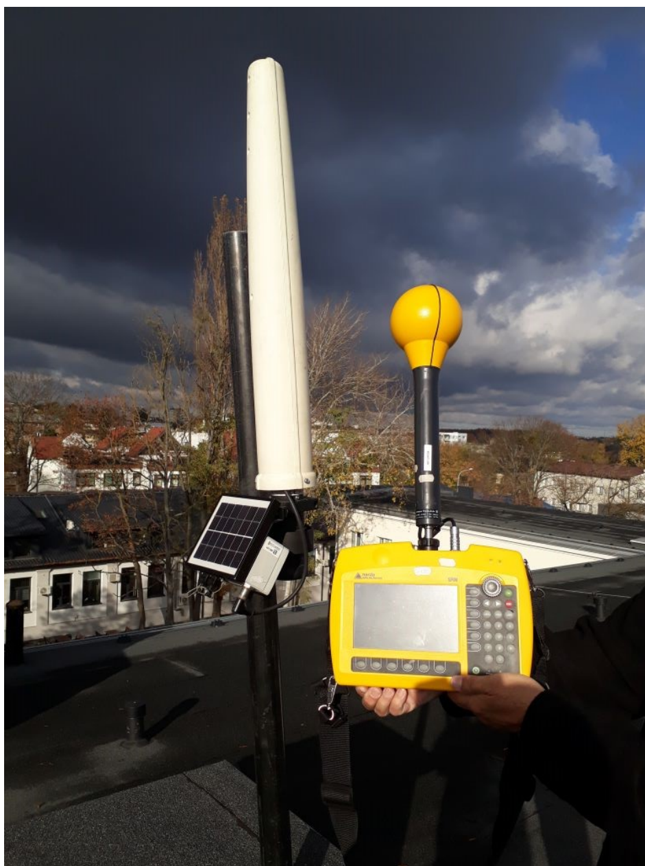
Rys. 9 Szkoła Podstawowa nr 18 w Lublinie – pomiary selektywne SRM-3600
