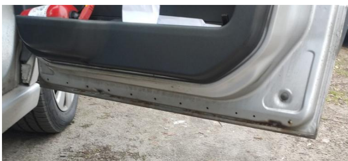
Drzwi przednie prawe - korozja
