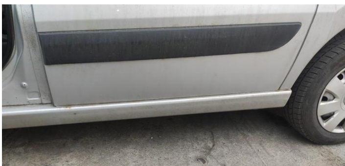
Poszycie progu prawego - skorodowane
