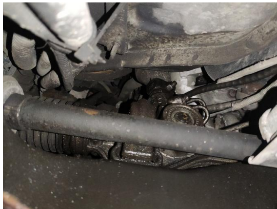
Przekładnia kierownicza - nieszczelna
