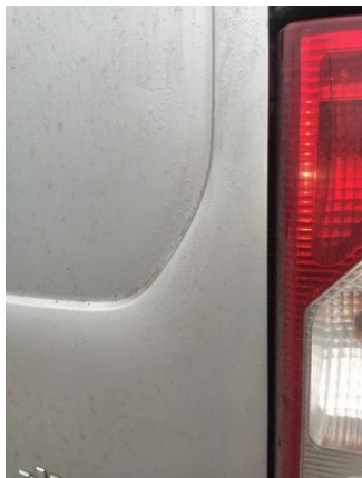
Drzwi tylne prawe - rozwarstwiona powłoka
