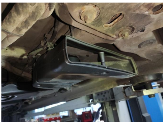
Chłodnica oleju napędowego - nieszczelna
