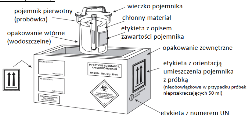
Ryc. 1. Schemat pakowania i etykietowania substancji zakaźnych kategorii A (przesyłanie pojedynczej próbki)
