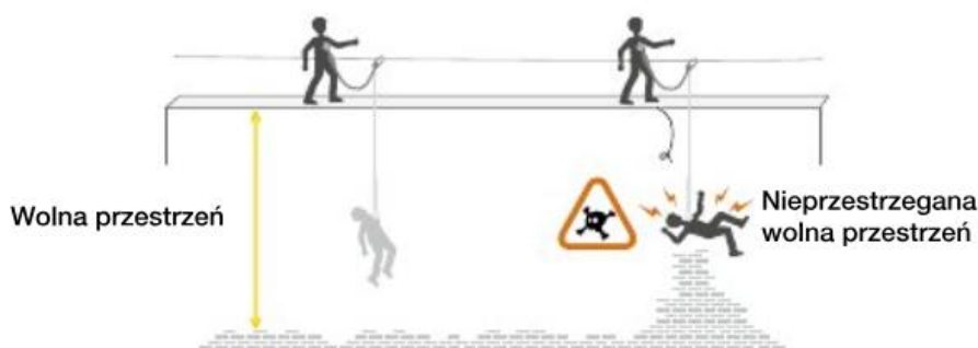
Rys. 20. Zasady zachowania wolnej przestrzeni pod ratownikiem
