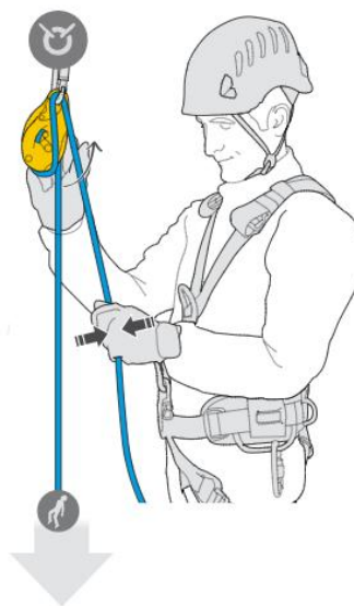
Rys. 14. Wydawanie luzu dla ratownika w technice jednej liny
