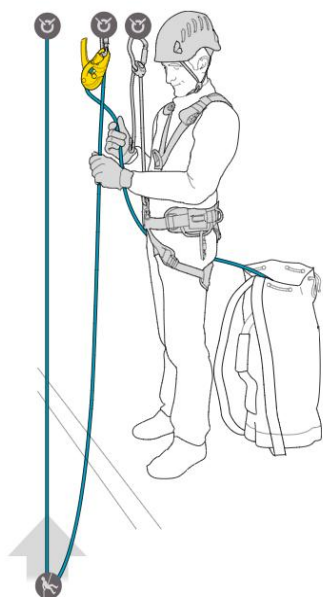
Rys. 13. Asekuracja ratownika przy poruszaniu się w górę w technice dwóch lin
