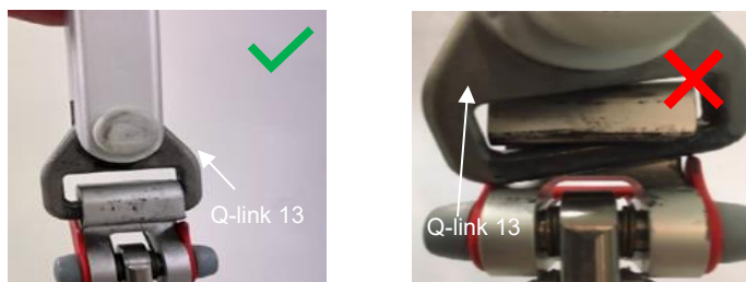
Rysunek 1. Prawidłowe vs Nieprawidłowe mocowanie Q-link 13 z szybkozłącznym hakiem
