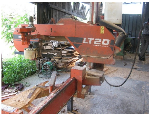
Trak taśmowy WOOD-MIZER typ LT-20SE 15S
