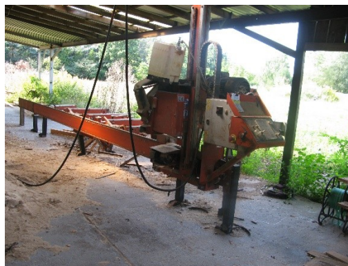
Trak taśmowy WOOD-MIZER typ LT-20SE 15S
