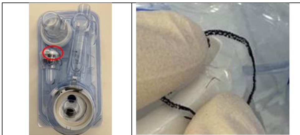
Ilustracja 1. Umiejscowienie defektu tacki i przykładowe pęknięcie
