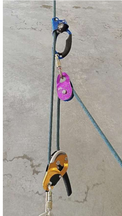
Zdjęcie 5 Układ „3:1” wykonany za pomocą przyrządu zjazdowego
