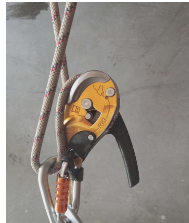
Zdjęcie 2 Wpięcie dodatkowego karabinka do punktu zbiorczego stanowiska
