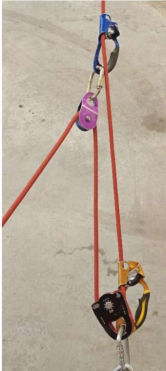
Zdjęcie 4 Układ „3:1” wykonany za pomocą blokera
