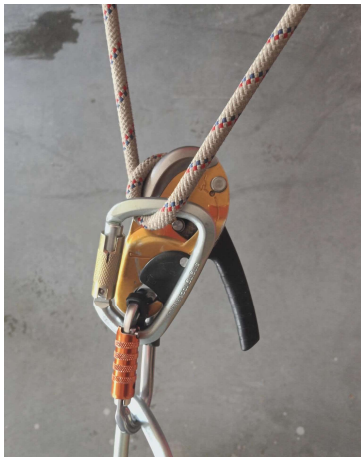
Zdjęcie 1 Wpięcie dodatkowego karabinka do karabinka przyrządu zjazdowego
