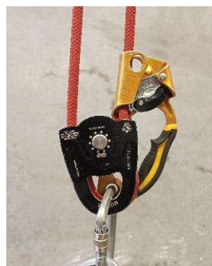
Zdjęcie 3 Bloker wykonany z przyrządu zaciskowego ręcznego i błočka pojedynczego
