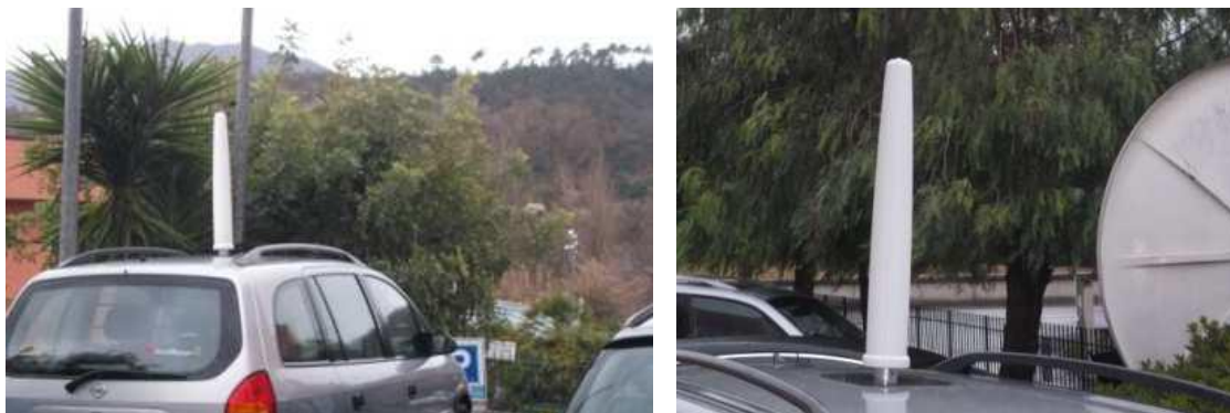
Rys. 37 Stacja monitorująca model AMB-8059-00 zamontowana na dachu samochodu
