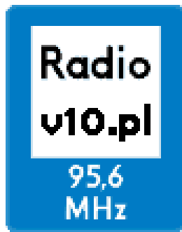
Rys. Z.7. Znak D-34a. Informuje o stacjach radiowych podających informacje o warunkach ruchu drogowego
