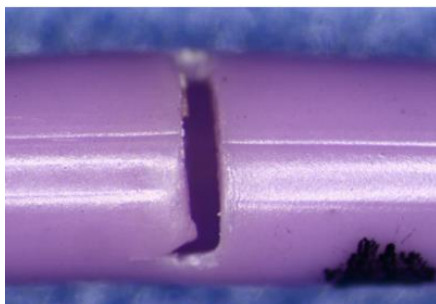
Ryc. 1: Przykład pęknięcia poprzecznego/obwodowego korpusu cewnika
