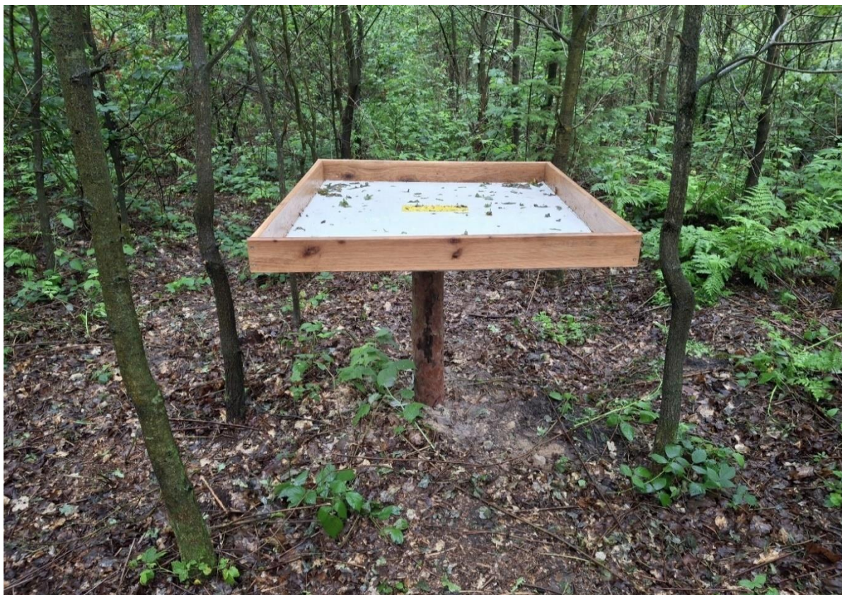
Fotografia 15. Taca opadowa do kontroli skuteczności oprysku na skoczonosą dębowca, leśnictwo Młyny, autor: Paweł Kaczorowski
