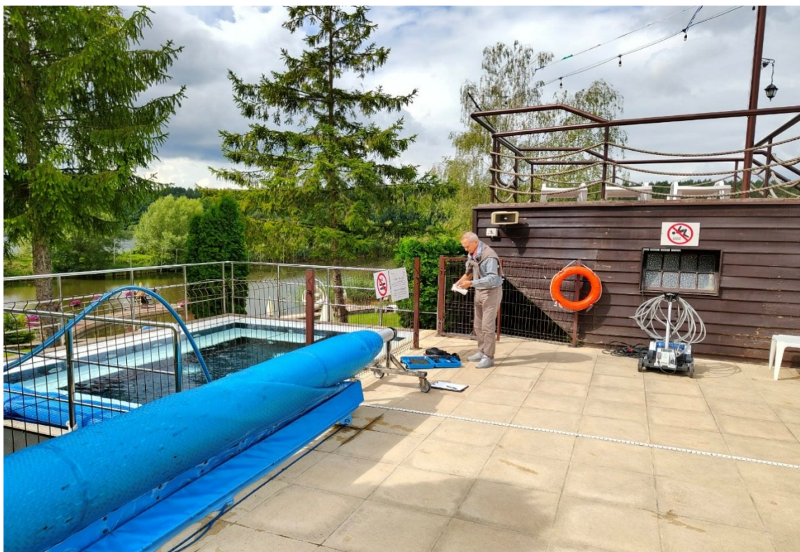
Zdjęcie 1 - kontrola jakości wody z niecki basenowej z hydromasażem na terenie Hotelu „Kormoran” w Sulęcinie (zdjęcie własne).
