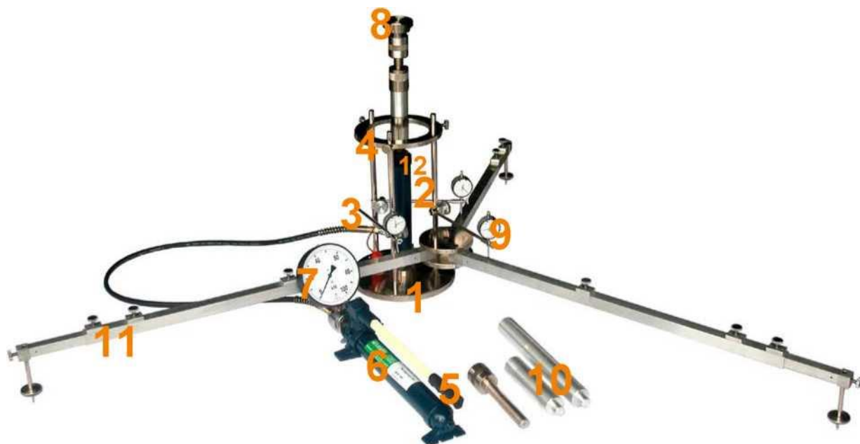
Rys. C.1. Przykładowa aparatura VSS z trzypunktowym pomiarem przemieszczenia płyty
