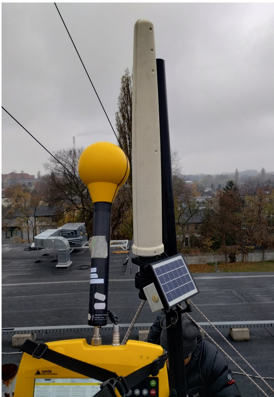
Rys. 9 SP nr 3 w Sosnowcu – pomiary selektywne SRM-3600
