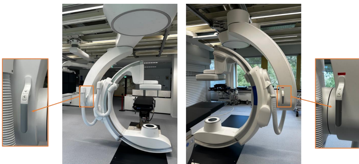
Ilustracja 3. Uchwyty z elementami sterującymi hamulcami po obu stronach pozycjonera FlexArm.
