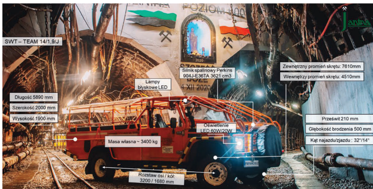
► Rys. 6. Parametry samojezdnego wozu transportowego SWT-Team 14/1,9/J
