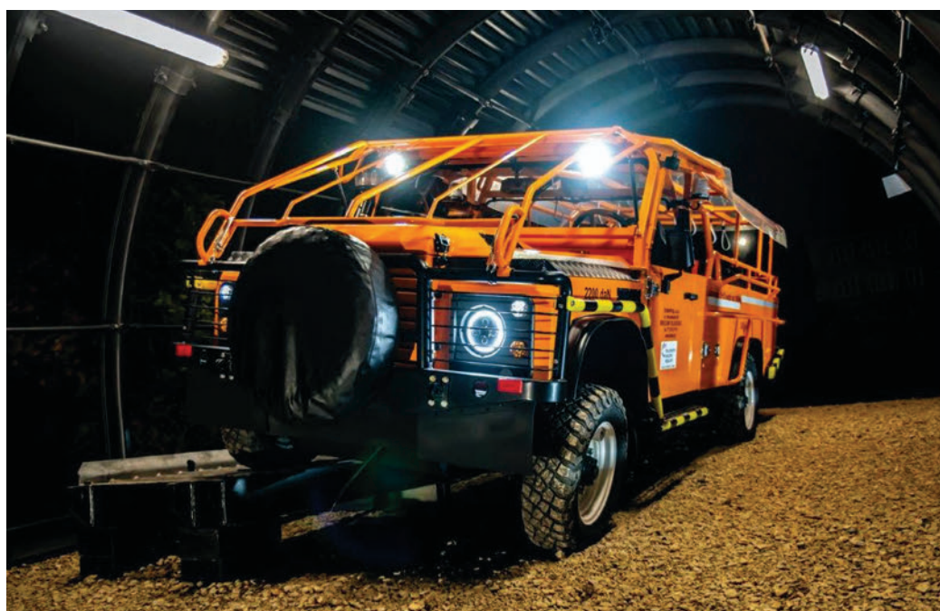
► Rys. 2. Samojezdny wóz transportowy SWT-Team 14/1,9/J
