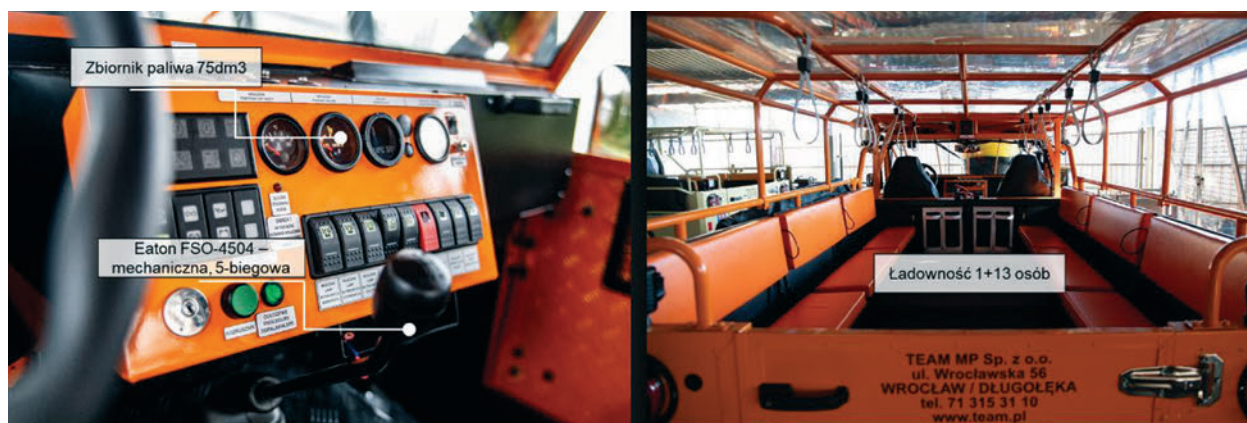
► Rys. 7. Elementy budowy samojezdnego wozu transportowego SWT-Team 14/1,9/J
