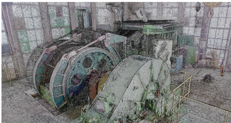
► Fot. 3. Chmura punktów maszyny wyciągowej szybu Lech II
