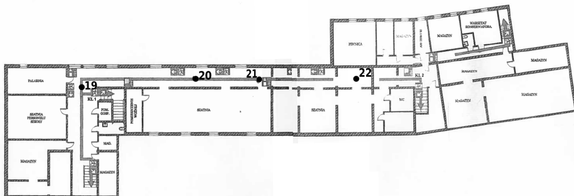
Rys. 1a: Plan rozmieszczenia punktów pomiarowych – piwnica,
