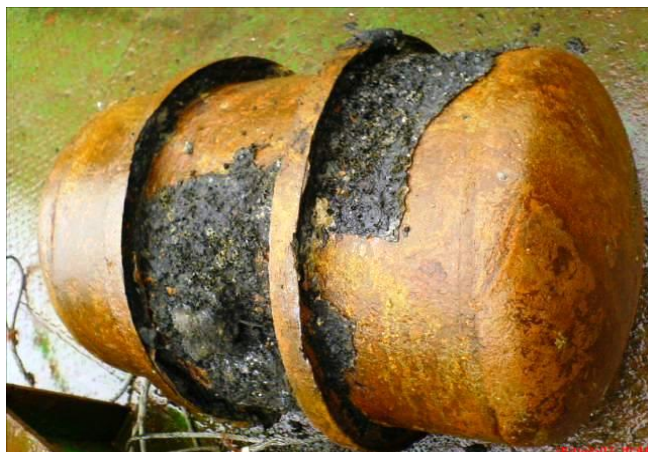
Rys. 18 Beczka grubościenna – zawartość ok. 150 kg bojowych lub ćwiczebnych środków bojowych, często używana również do gromadzenia związków ropopochodnych
