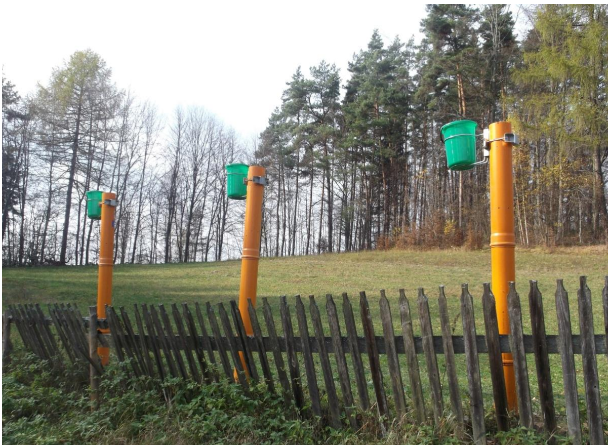
Fot. 2.2. Kolektory na otwartej przestrzeni do pomiaru w okresie zimowym depozytu mokrego zainstalowane na powierzchni monitoringu intensywnego nr 816 w Nadleśnictwie Piwniczna
