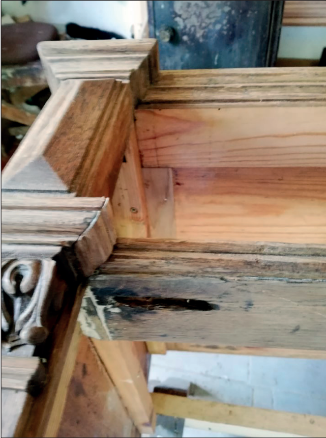
5. Środkowa szafka nadstawy. Widoczne plamy atramentowe spowodowane przez rdzewienie zawiasów czopikowych, fot. P. Hapka
