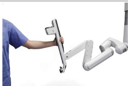
Ilustracja 2: Ilustracja przedstawiająca prawidłowy sposób trzymania manipulatora USM podczas ręcznego pozycjonowania
