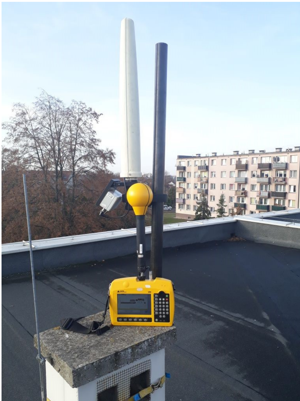
Rys. 9 Przedszkole nr 3 w Płocku – pomiary selektywne SRM-3600
