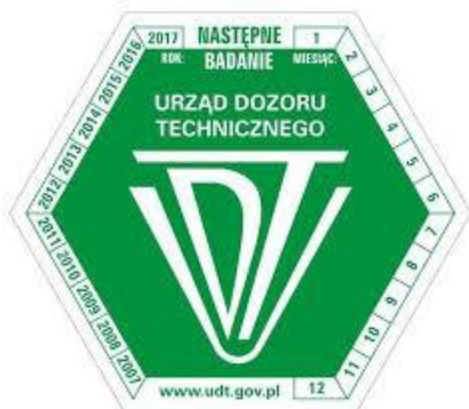
rys. 9 Oznaczenie następnego badania butli kompozytowej za pomocą naklejki
