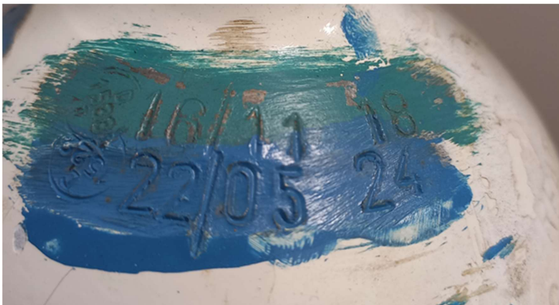
rys. 8 Oznaczenia ostatniego i następnego badania butli nurkowej
