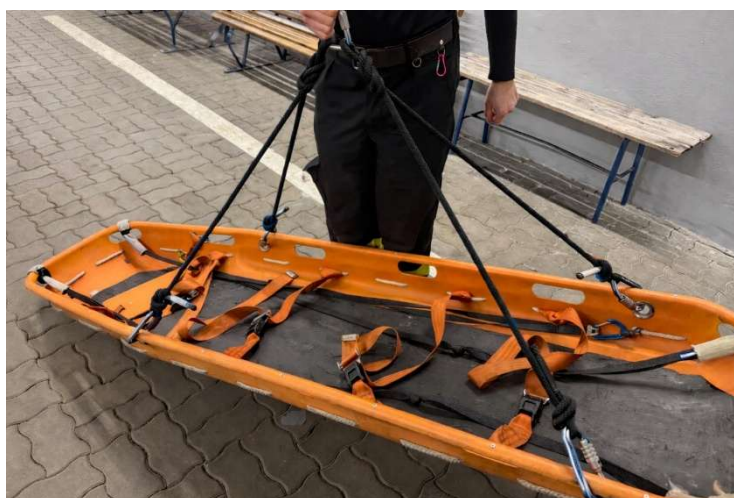
Fot. 7. Nosze wannowe z podpiętymi zawieszami
