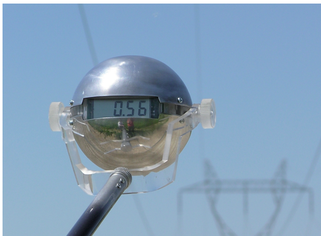
Fot. 4. Widok miernika CMP-7 z dipolem kulistym w sąsiedztwie linii wysokiego napięcia
