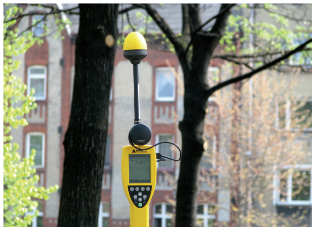
Fot. 2. Miernik pól elektromagnetycznych NARDA w trakcie realizacji zadań monitoringowych
