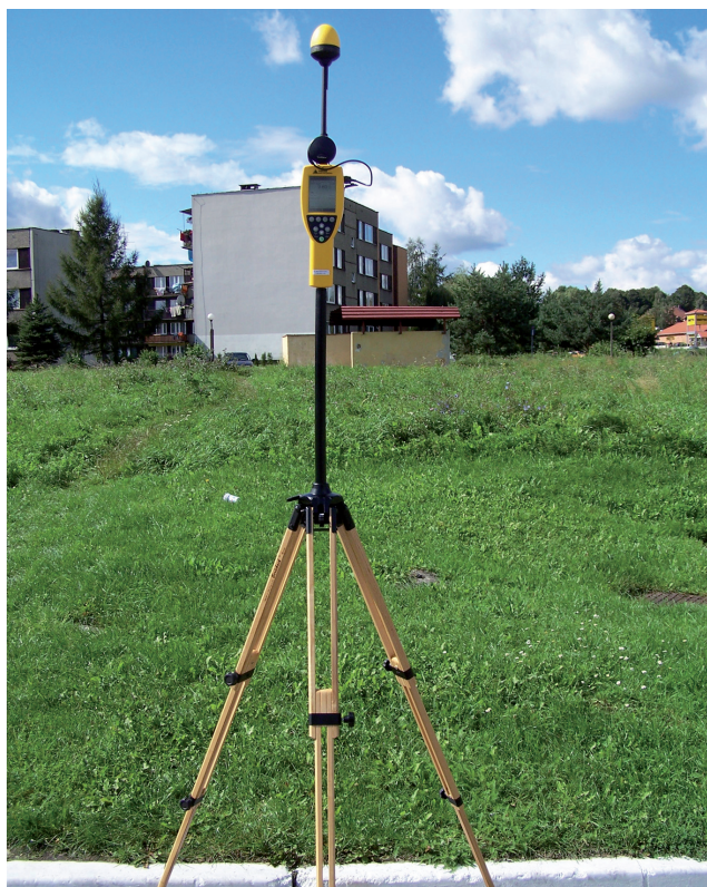
Fot. 1. Miernik pól elektromagnetycznych NARDA w środowisku, w sąsiedztwie zabudowy wielorodzinnej
