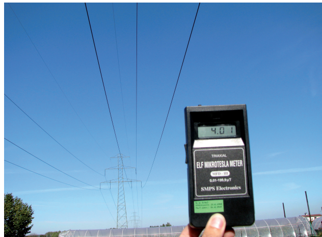
Fot. 6. Trójosiowy miernik indukcji magnetycznej ELF usytuowany pod siecią elektroenergetyczną
