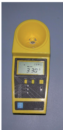
Fot. 8. Ultradźwiękowy miernik zawieszenia wysokości przewodów wysokiego napięcia serii Supa Rule TM
