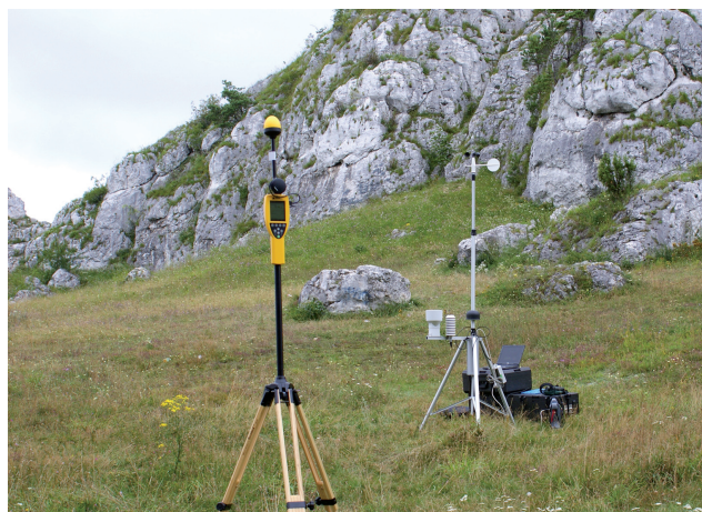
Fot. 10. Miernik pól elektromagnetycznych NARDA oraz stacja meteorologiczna Vaisala wykorzystywane w pomiarach monitoringowych
