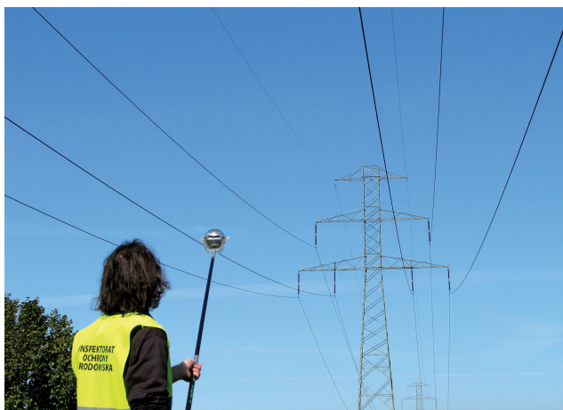
Fot. 5. Pomiar miernikiem CMP-7 z dipolem kulistym w sąsiedztwie linii wysokiego napięcia
