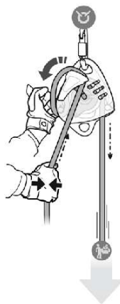
Rys. nr 3. Opuszczanie przyrządem do ratownictwa / transportu pionowego MAESTRO S Petzl.
