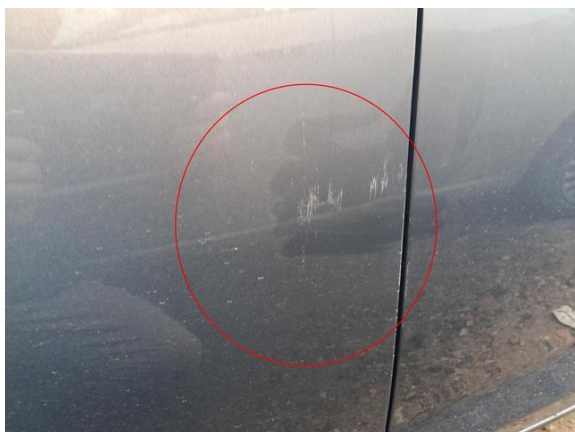
uszkodzenia poszycia drzwi przednich lewych
