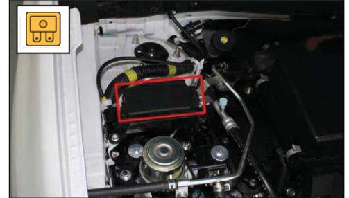
2. „Power Unit Control“-Sicherung entfernen (Nr. F7, 10 A)
