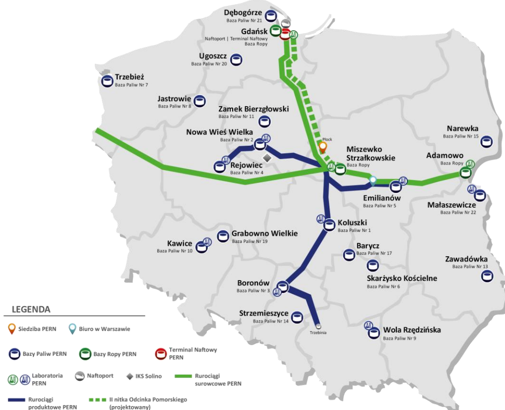
Rysunek 4.10. Poglądowy układ infrastruktury spółki PERN S.A. (stan na 2024 r.)
