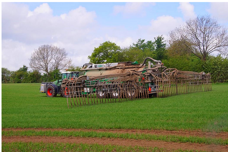
Fot. 13. Zakwaszanie gnojowicy w systemie „in field”
