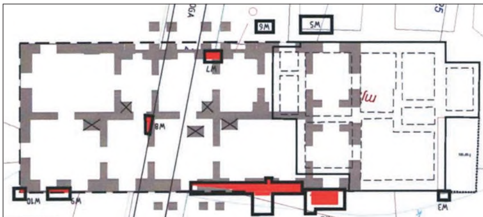
8. Nadolce, dwór, rzut parteru, wyniki badań architektonicznych przeprowadzonych przez Urszulę Fidecką w l. 2018-2019.
