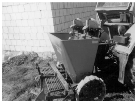
Czesława M. w czasie sadzenia ziemniaków przebywała na pomoście sadzarki, strącając nadmiar sadzeniaków z kubelków podajnika. Palec kobiety dostał się między czerpak i górną osłonę i został obcięty . fot. – OR Przeworsk
