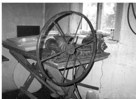
Bożena T. przygotowywała półprodukty z mięsa po świniobiciu, mieląc je na maszynie z dorobionym domowym sposobem napędem elektrycznym. W czasie popychania mięsa dotknęła ślimaka i straciła opuszkę palca. Konstruktor tego napędu też doznał urazu palców w maszynie do mięsa – fot. OR Grudziądz
