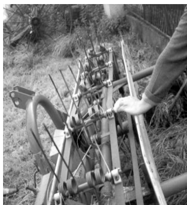
Roman T. przetrząsał siano przy pomocy przetrząsaczo-zgrabiarki. Kiedy stwierdził, że maszyna nie pracuje należycie, zatrzymał ciągnik nie wyłączając napędu WOM i przystąpił do regulacji. Palec ręki dostał się między obracające się koło napędzające i pasek klinowy.
