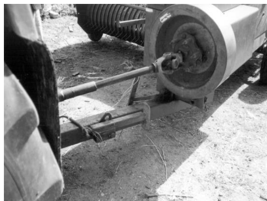
Nieosłonięty wał napędowy prasy zbierającej do słomy
