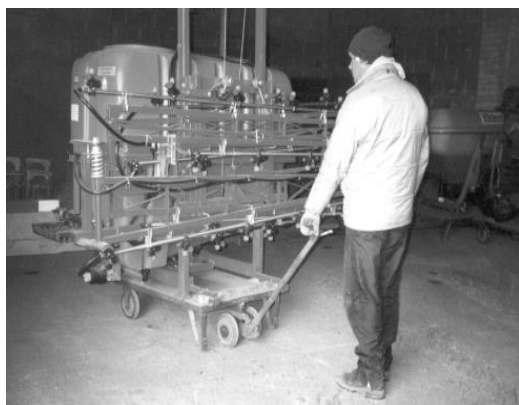
Wózek usprawniający przechowywanie i sprzęganie maszyn zawieszanych, wykonany przez jednego z rolników fot. OR Żyrardów
