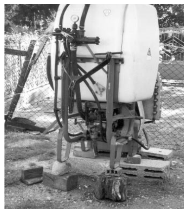
Niebezpieczny sposób przechowywania maszyn zawieszanych fot. OR Żyrardów
