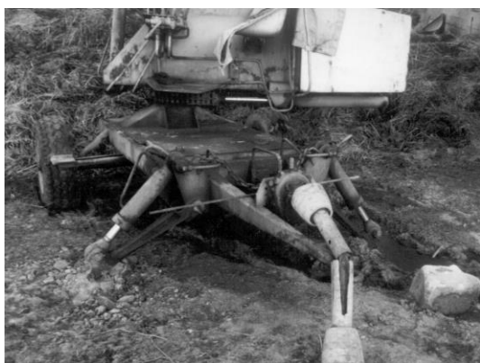
Jan B. pośliznął się i upadł na wał przegubowo-teleskopowy z uszkodzoną osłoną, doznając złamania żeber, pęknięcia śledziona i uszkodzenia innych narządów wewnętrznych fot. OR Zambrów
