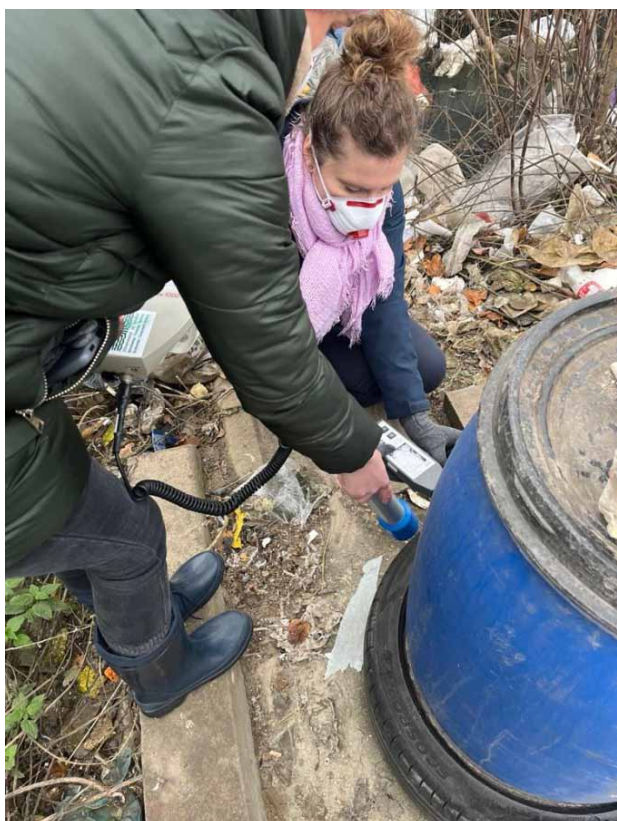
Fot. 2. Pomiar przestrzennego równowaznika mocy dawki wokół wydzielonych odpadów
