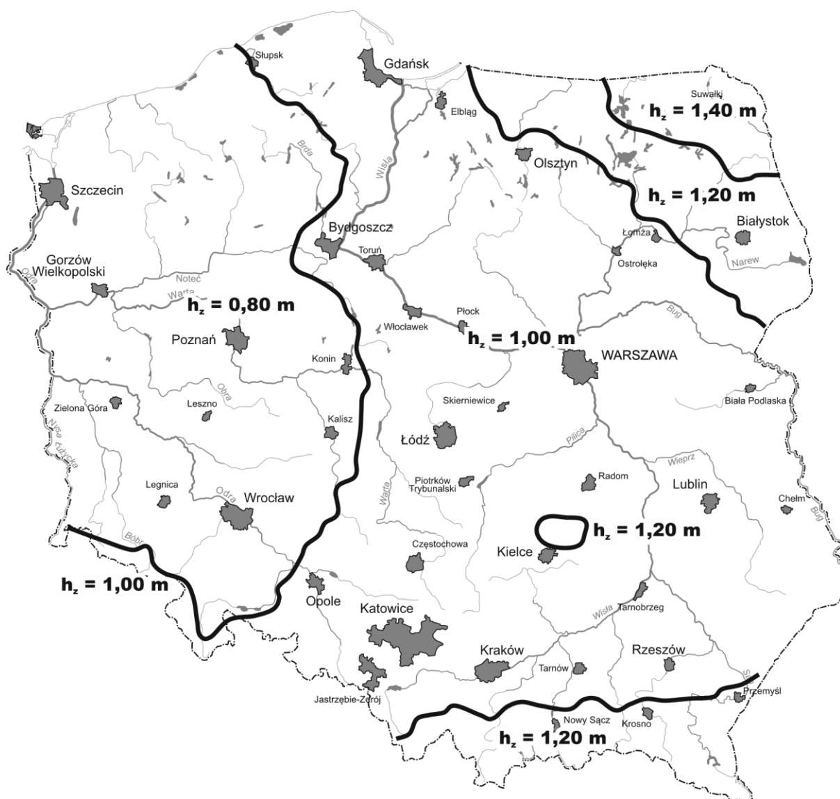
Rys. 10.1. Głębokość przemarzania gruntu h_z wg PN-81/B-03020
