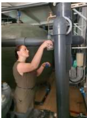
Zdjęcie 12., 13. Pobór próbek wody z systemu cyrkulacji niecek pływackich
