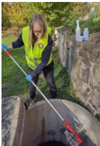
Zdjęcie 47. Pobór próbki wody do badań ze studni przydomowej
