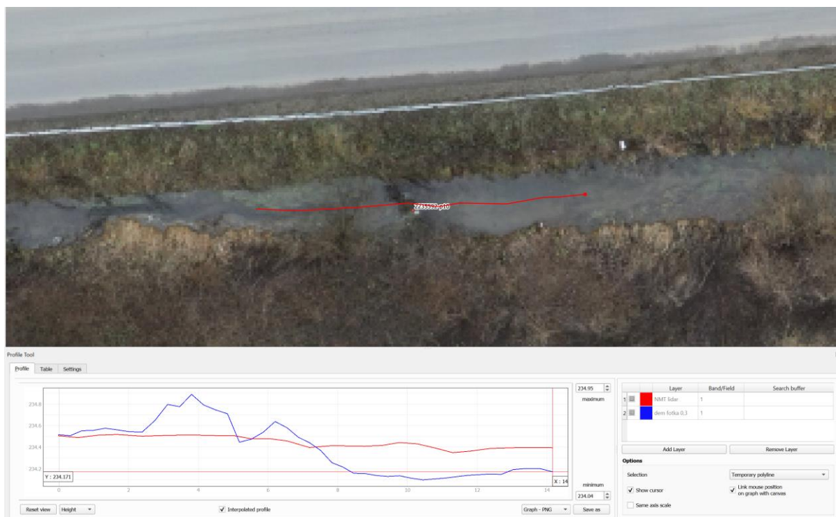
Ryc. 8. Przykład opisanej w tekście znacznej odchyłki pomiarów z wykorzystaniem NMT LiDAR (linia czerwona) a modelem DEM (linia niebieska).
