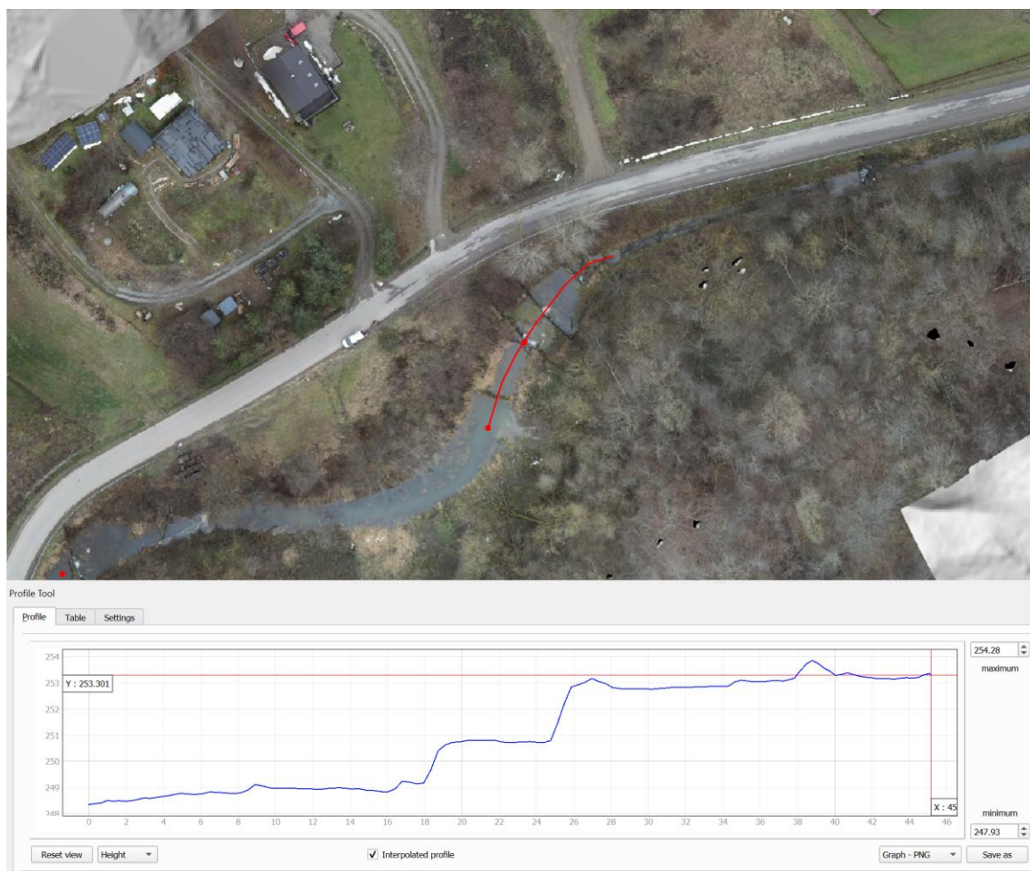
Ryc. 4. Fragment ortomozaiki z widocznymi budowlami i tamą bobrową oraz przekrój podłużny wykonany na bazie modelu DEM (km ok. 1+350).
