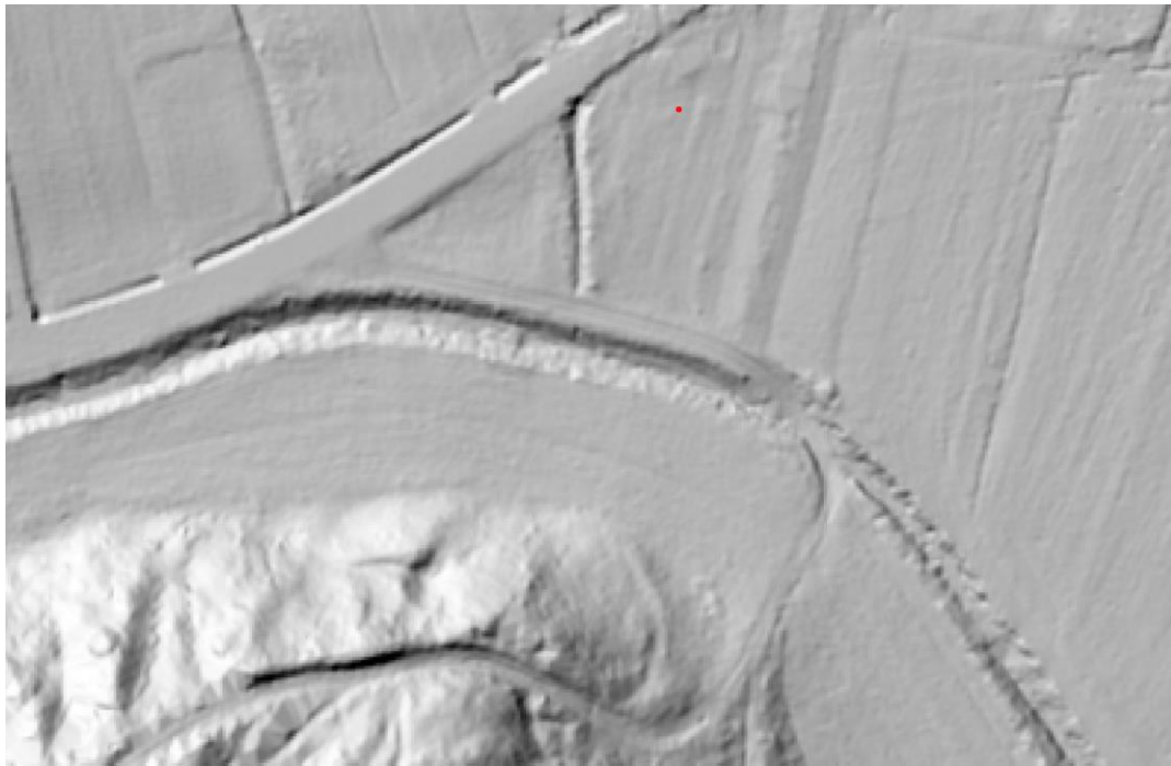
Ryc. 2. Fragment NMT ze skanu LiDAR o rozdzielczości piksela terenowego 0,5 m (km ok. 0+400).
