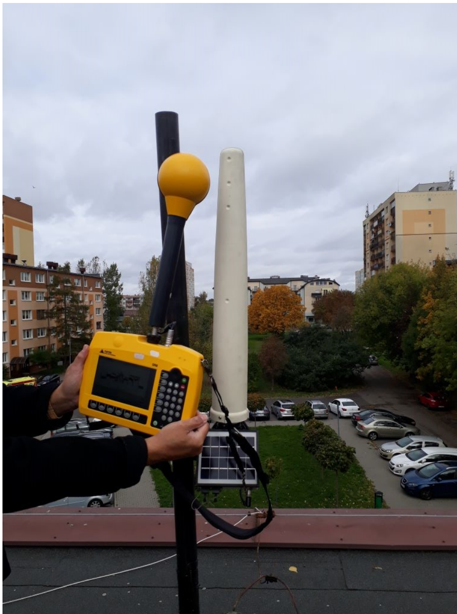
Rys. 10 Przedszkole nr 20 w Piotrkowie Trybunalskim – pomiary selektywne SRM-3600
