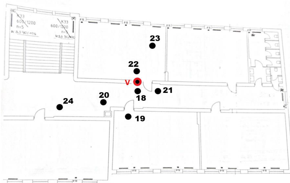
Rys. 1d: Plan rozmieszczenia punktów pomiarowych – II piętro (część 2), kolorem czerwonym oznaczono lokalizację punktów dostępowych
