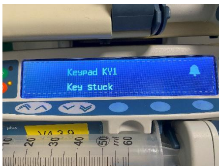
Zdjęcie 2: Wyświetlany błąd KY1/Stuck Key (zablokowany przycisk)
