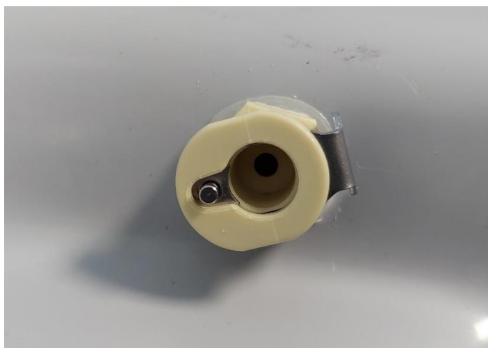
Rys. 1: Gniazdo testu szczelności w zbiorniku
