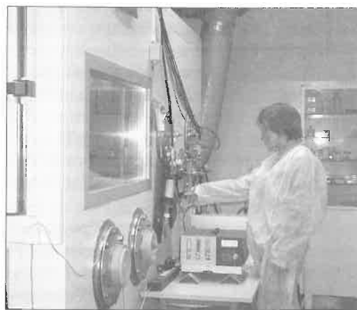
Rys. 4. Radonowa komora kalibracyjna w CLOR
